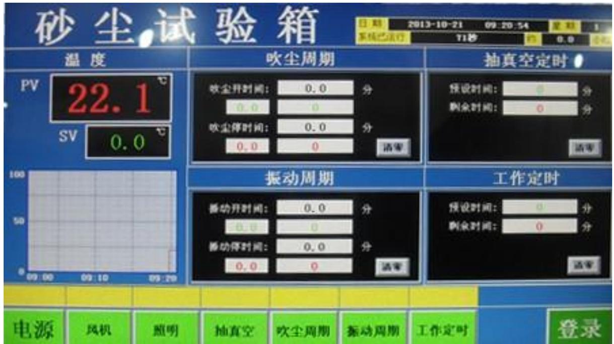
运行方式：采用触摸屏操作控制、运行温度、吹尘周期、振动周期、抽真空定时、工作定时等参数
